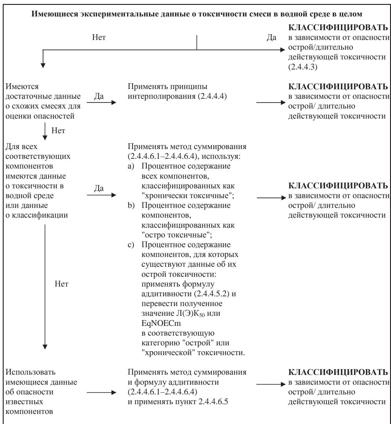
Рисунок 2.4.4.2 Ярусный подход к классификации смесей в зависимости от их острой и длительно действующей токсичности в водной среде
