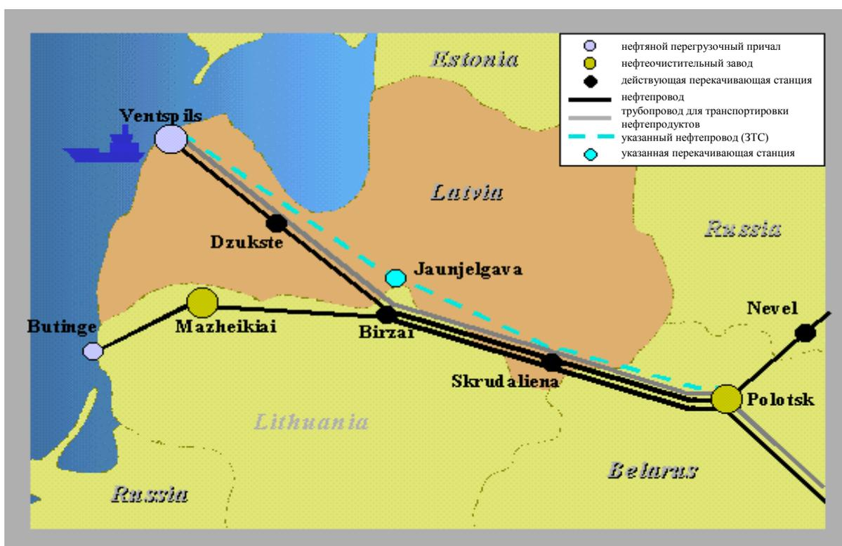
Проект ЗТС предполагает поэтапное увеличение транзитного потенциала действующей трубопроводной системы на основе строительства параллельных трубопроводных сегментов - петель с учетом увеличения гарантированных поставок сырой нефти. На заключительном этапе эти петли будут соединены с новыми трубопроводными сегментами в рамках нового автономного нефтепровода "Полоцк - Вентспилс" протяженностью 526 км.
