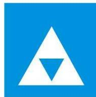
E.5.6 Aire de stationnement réservée aux bateaux de la navigation par poussage astreints à porter les deux feux bleus ou les deux cônes bleus en vertu de l'article 3.14, paragraphe 2 (voir article 7.06)
