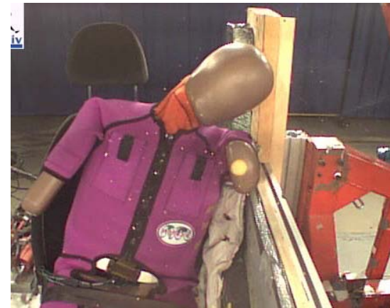
Sled test – EuroNCAP MDB WorldSID 50%-ile
