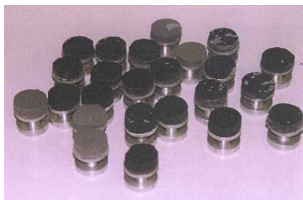
Пример испытательных плиток с вырванным слоем полиуретанового материала (испытание на адгезию)
