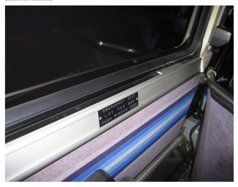
Figure 2 **Issue de secours coulissante faisant partie de la fenêtre** (l'ensemble de la fenêtre est fixé au montant, mais une partie utilisée en tant qu'issue de secours coulissante)
