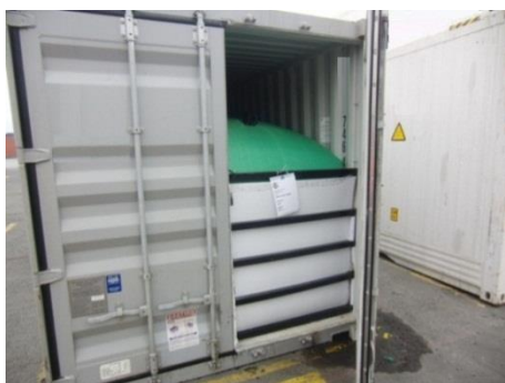
Figure 7.51 - Conteneur équipé d'une citerne souple
