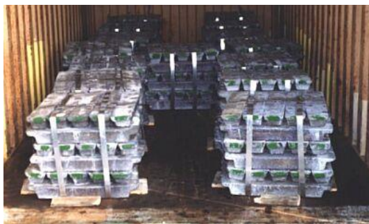
Figure 7.19 - Unitarisation de lingots de métal au moyen de bandes d'acier (non assujettis)
