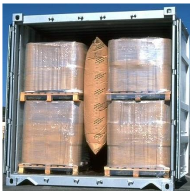
Figure 7.9 - Espace rempli par un sac d'arrimage central
