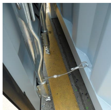
Figure 5.30 - Sangle de retenue de porte
