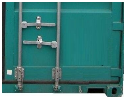
Figure 5.27 - Poignées entre les barres
