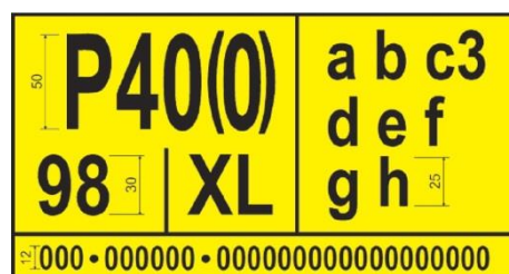
Figure 4.5 - Marque d'exploitation jaune pour remorque
