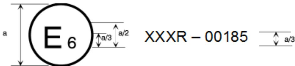
La marque d'homologation ci-dessus, apposée sur un véhicule, indique que le type de véhicule visé a été homologué en Belgique (E6) en ce qui concerne le système de contrôle de stabilité, en application du Règlement n° XXX. Les deux premiers chiffres du numéro d'homologation indiquent que l'homologation a été délivrée conformément aux prescriptions du Règlement n° XXX sous sa forme originale.
