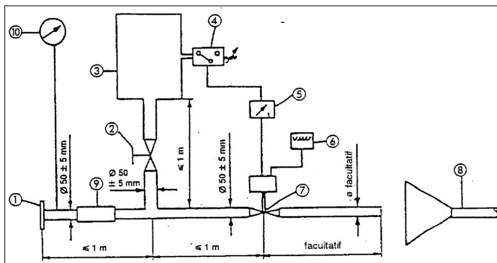
1. Bride d'admission ou manchon de raccordement à l'arrière du dispositif d'échappement à essayer.
