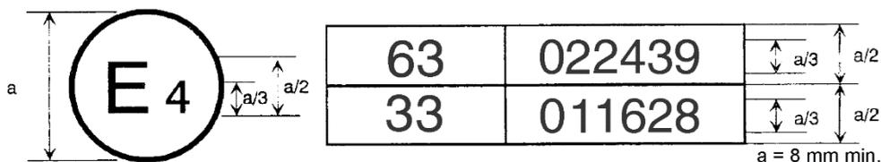
La marque d'homologation ci-dessus, apposée sur un véhicule, indique que le type de ce véhicule a été homologué aux Pays-Bas (E4), en application des Règlements n°s 63 et 33<sup>1</sup>. Les numéros d'homologation signifient qu'aux dates où les homologations respectives ont été délivrées, le Règlement n° 63 comprenait déjà la série 02 d'amendements et que le Règlement n° 33 avait été aussi modifié, par la série 01 d'amendements.
