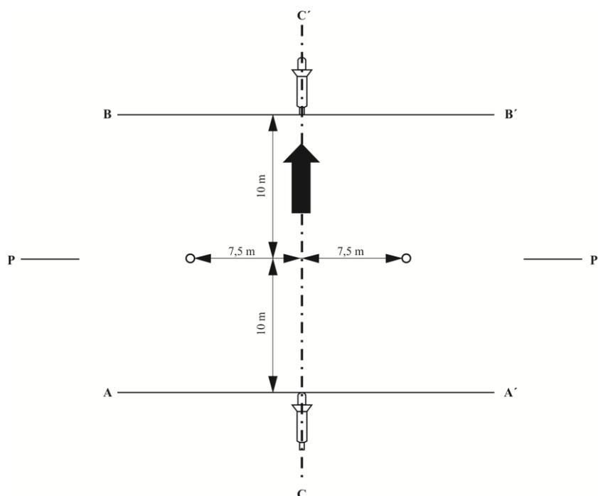
Deux lignes, AA' et BB', parallèles à la ligne PP' et situées respectivement à 10 m en avant et en arrière de cette ligne, seront tracées sur la piste d'essai.
