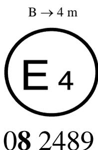
La ceinture portant la marque d'homologation ci-dessus est une ceinture sous-abdominale ("B") pourvue d'un rétracteur du type 4 à sensibilité multiple (m) et homologuée aux Pays-Bas (E4) sous le numéro 0682489, le Règlement contenant déjà la série 068 d'amendements au moment de l'homologation.
